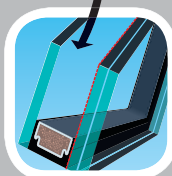
VIDRIO DE SEGURIDAD L3: Vidrio exterior templado con capa de fácil limpieza y un vidrio interior laminado, con capa de baja emisividad, ensamblados en un marco TGI. Cámara rellena de gas argón.
