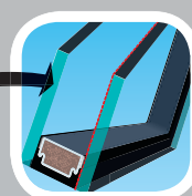
VIDRIO TERMOAISLANTE U3 -Vidrio exterior templado, vidrio interior con capa de baja emisividad, ensamblados en un marco aislante TGI. Cámara rellena de gas argón.
