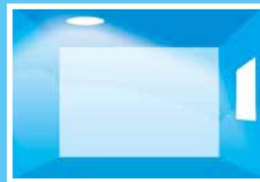
luz) y de la colocación del mobiliario, este sería el esquema básico de la ubicación de la lucerna en una habitación con ventana. Las esquinas, debido a dos fuentes de luz natural quedan muy bien iluminadas. La aproximación excesiva de la lucerna hacia la pared opuesta a la ventana, puede causar una menor intensidad de luz en la zona central.
