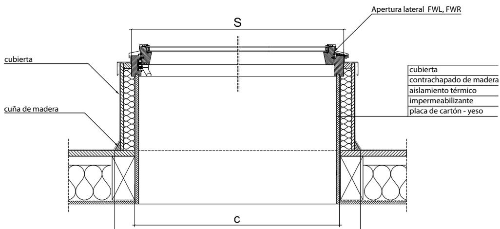
Corte de sección de ventana aperrura lateral FWL/R con tapajuntas EFW en cubiertas sin inclinación.
